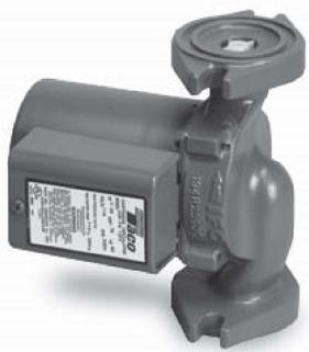
Las bombas recirculadoras de cartucho Taco Serie 00 son sólidas, versátiles, de instalación fácil y rápida. Con su diseño autolubricante y sin sello mecánico, proporcionan una confiabilidad incomparable que hace que no requieran mantenimiento, estas cuentan con un cartucho reemplazable que contiene todas las partes móviles (rotor, flecha e impulsor).
